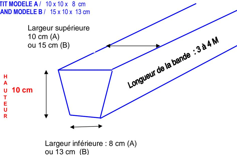
**LA DÉCLIVITÉ DES FACES INCLINÉES VERS LE TERRAIN ENTRE LARGEUR SUPÉRIEURE et LARGEUR INFÉRIEURE EST TOUJOURS de : 1 cm**
